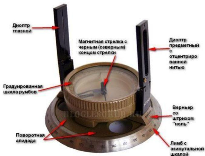
Буссоль (фр. boussole «компас») – геодезический инструмент для измерения углов при съёмках на местности, специальный вид компаса. Имеет визирное приспособление. Шкала буссоли часто бывает направлена против
